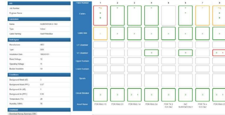
Beispiel für die Klassifizierung von Messwerten an Anlagen. Diese können zur Analyse entweder auch optional an die Experten von EA Technology übertragen oder durch eigene Experten beurteilt werden.
